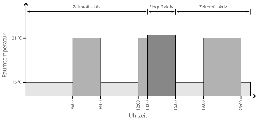
Abb. 4: Darstellung des Heizverlaufs innerhalb eines Tages gemäß Vorgabe des Geniax Zentralbediengerät es (Zeitprofil mit drei angelegten Zeitbereichen); Eingriff über das Raumbediengerät Basic Control um 13:00 Uhr
